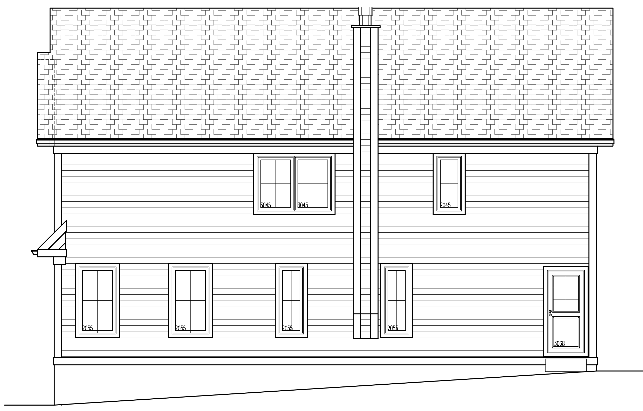
1E A200 REAR ELEVATION OPTION A 1/4"=1'-0"
